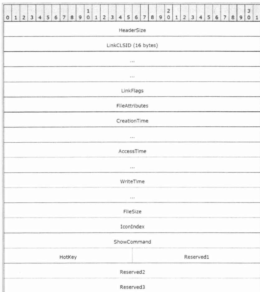
Рис. 2.5. Структура блока SHELL_LINK_HEADER
